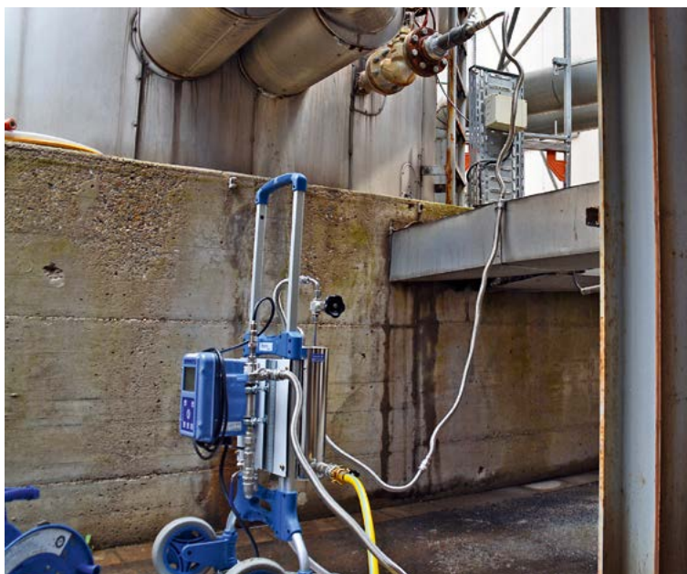
Abbildung 3: Mobile Sauerstoff-Messapparatur im Einsatz vor Ort
